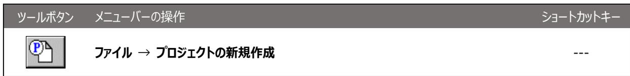
プロジェクトの新規作成ダイアログが起動します。<プロジェクト名>と<位置>(保存先)を設定してください。設定後、**プローブ** ボタンを押してください。
