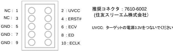
10芯DSUコネクタピン配置(上面視図)
