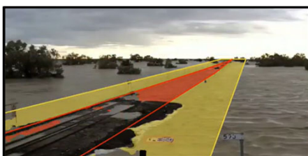
画像による水面検知 洪水による線路冠水状態を検出しアラームを発出
