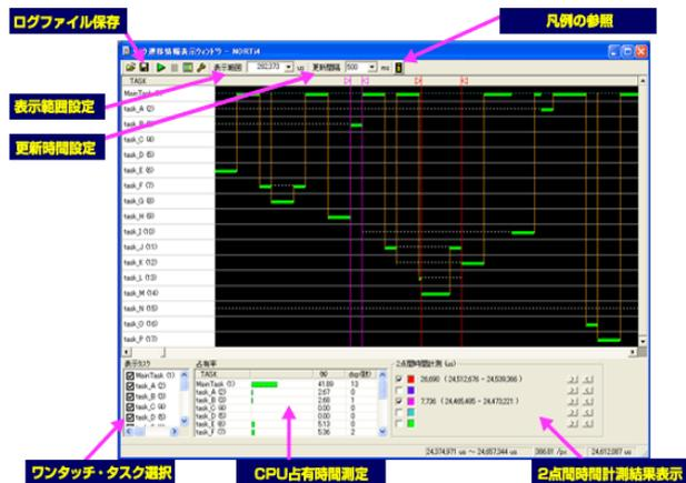
OSの各タスク遷移情報を時系列に参照することが出来ます。また、各タスクの占有率をグラフィカルに確認することも出来ます。プロファイルを行い、設定時間内に各タスクが完了するようタスク実行時間改善・優先度修正などのタスクフロー最適化対策のための指標としてお使いいただけます。\*1
