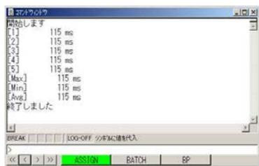
指定された測定範囲のCPU実行時間を測定します。プログラムの実行時間計測に使用できます。また、繰り返し回数を指定する事により、各回の実行時間や平均実行時間を求める事ができます。トレース機能を持たないCPUでも測定可能です。\*4
