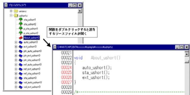
プロジェクトウィンドウには現在ダウンロードされているモジュールのファイル名やリンクされたソースファイル名、ソースファイル内の関数名などが階層的に表示されます。ファイル名のダブルクリックでそのファイルのソースウィンドウが開き、関数名のダブルクリックで関数が定義されている位置にカーソルが移動し、関数のソースを表示します。素早く目的のデバッグポイントに移動できます。
